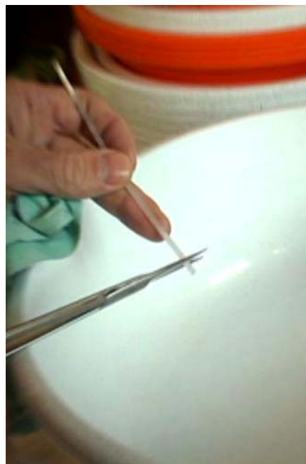
Obrázek 13: Odstřížení kontaminovaného konce pejety vodou
