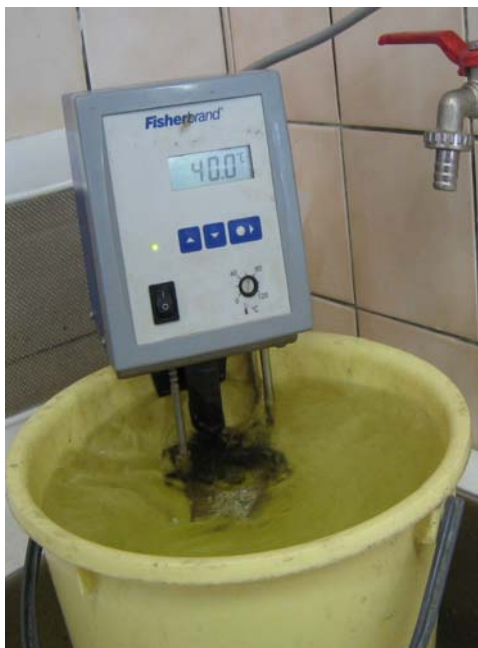
Obrázek 12: Lázeň o teplotě 40°C připravená pro rozmrazování
