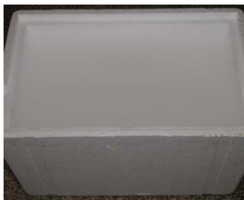
Obrázek 8: Polystyrénový box o hloubce 35 cm s výškou hladiny kapalného dusíku 7-10 cm
