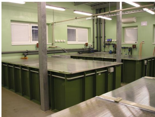
Obr. č. 6 Zakrytí odchovných nádrží komůrkovým polykarbonátem proti vyskočení ryb z bazénu a snížení vlhkosti vzduchu v hale výparem vody z hladiny (FROV JU Vodňany, foto D. Gela)
