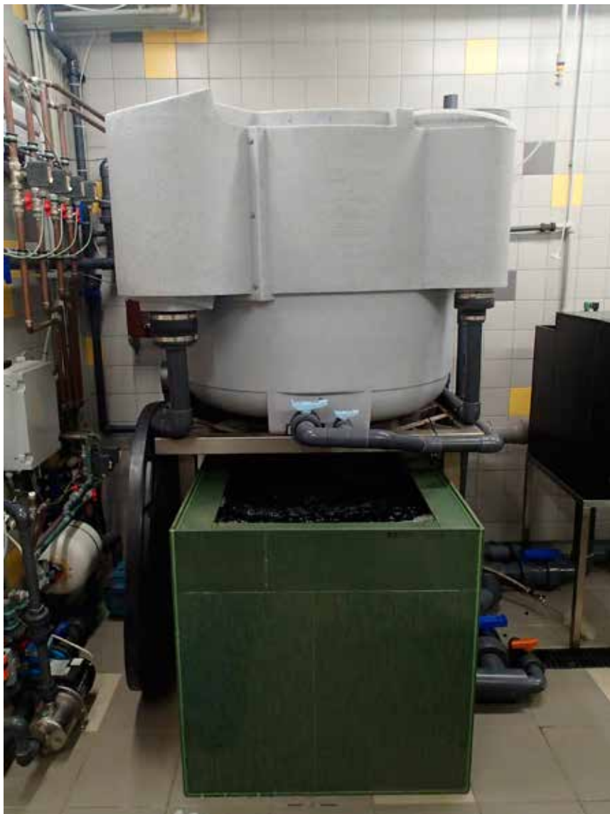
Obr. 7. Biologická filtrace, která byla tvořena předfiltrem Nexus 310 a airliftovým biologickým filtrem vlastní konstrukce (FROV JU), využívaná v RAS během realizace poloumělých výtěrů candáta obecného ( Sander lucioperca L.) (foto T. Policar).
