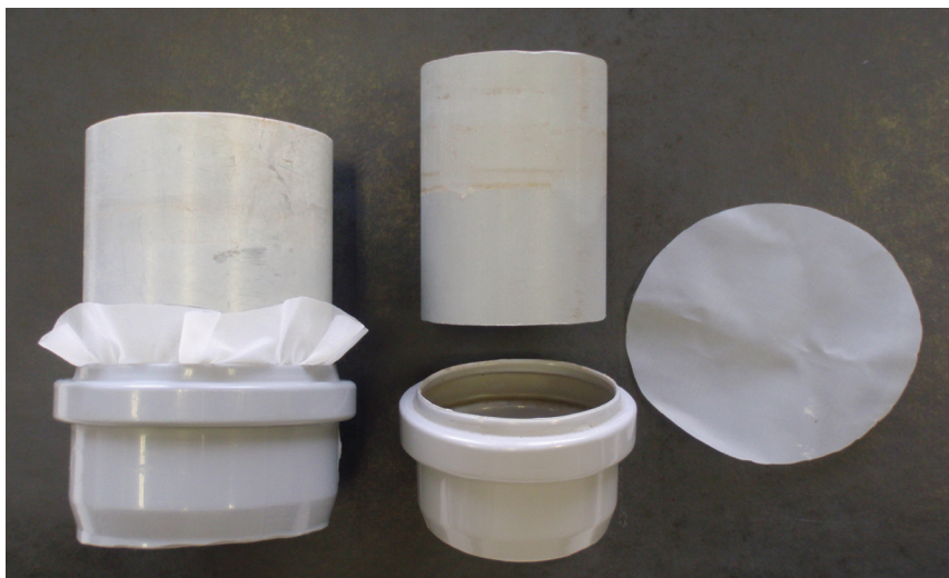
Obr. 7: Znáznornění sítěk vytvořených z odpadního systému HT s možností použití různě jemné filtrační tkaniny (uhelonu).
