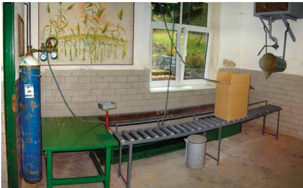
Obr. 3.9. K zvládnutí expedice velkého objemu \dot{S}_0 v průběhu několika dní byla na štičí líhni v Táboře postavena speciální balicí linka (foto J. Regenda).
