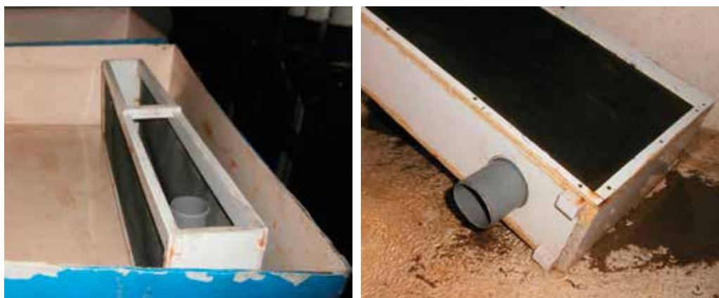
Obr. 3.25. Konstrukce zabezpečení odtoku vody z nádrže proti úniku plůdku s vodou s velkou cedící plochou (foto J. Regenda).
