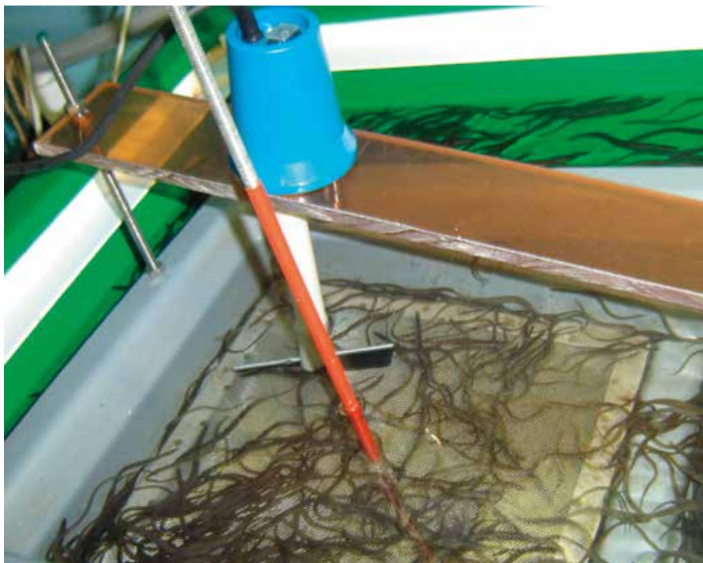
Obr. 3.26. Automatické čistící zařízení sít na odtoku vody z nádrže sestavené s pomocí z elektrického grilovacího motorku. Na prodloužené hřídeli je upevněn kartáč vyrobený z těsnícího prvku dveří. V tomto případě použito při odchovu násady úhoře (foto J. Regenda).
