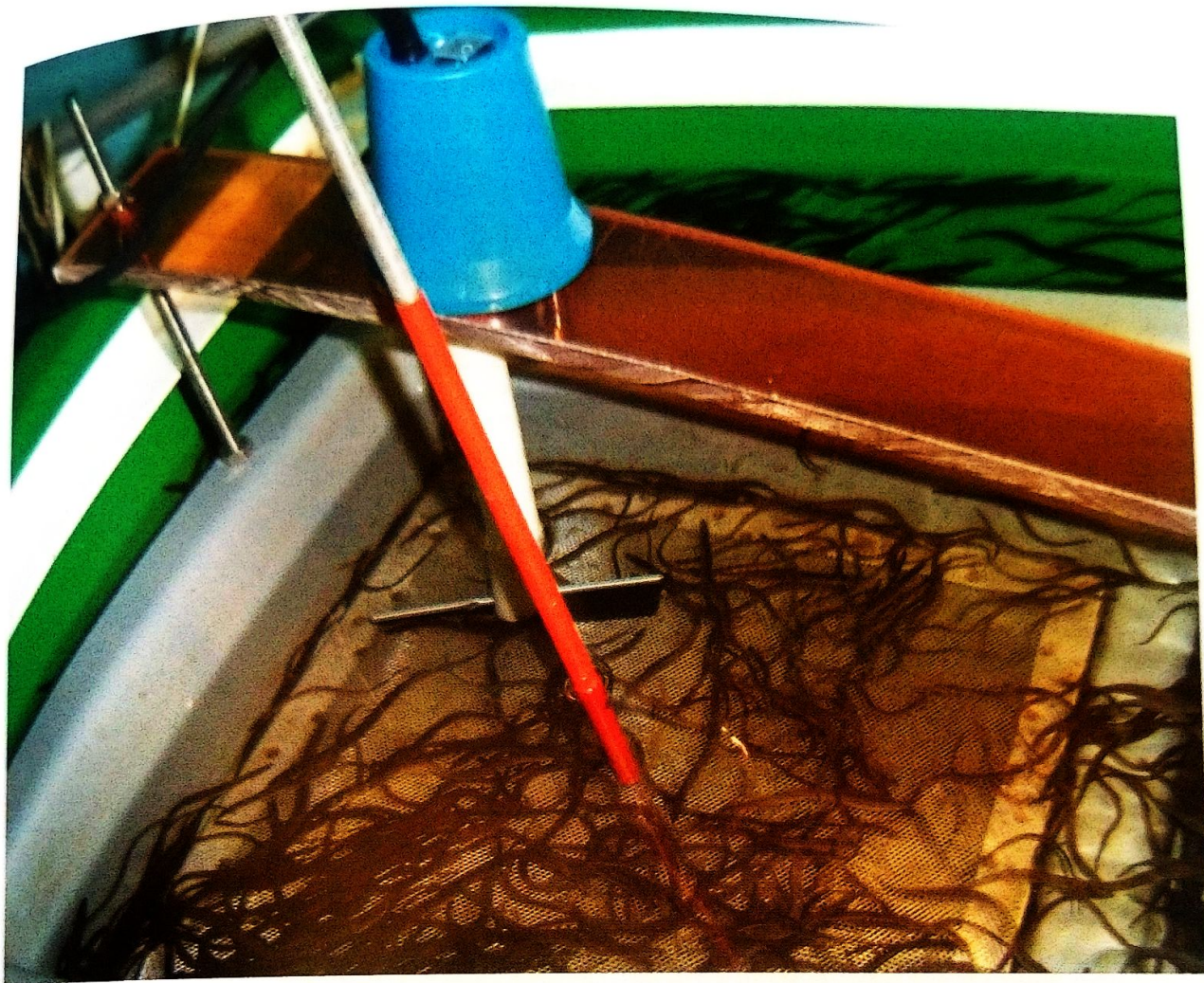
Obr. 3.26. Automatické čistící zařízení sít na odtoku vody z nádrže sestavené s pomocí z elektrického grilovacího motoru. Na prodloužené hřídeli je upevněn kartáč vyrobený z těsnicího prvku dveří. V tomto případě použito při odchovu násady úhoře (foto J. Regenda).
