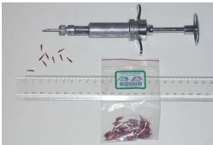
Obr. 2.4. Mikročipové značky typu P.I.T. tags (pracovní frekvence 134,2 kHz) a sterilizovatelný aplikátor ke značkování generačních ryb. Z archivu M. Flajšhanse (1998).
