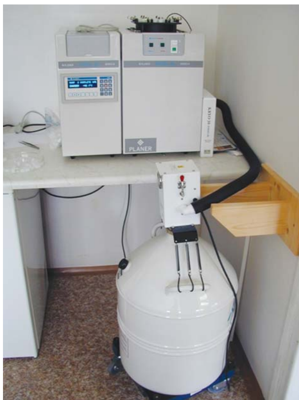
Obr. 2.5. Zamrazovací automat Planer Kryo 10, používaný ke kryokonzervaci semenných dávek ryb ve FROV JU ve Vodňanech. Z archivu M. Rodiny (2002).
