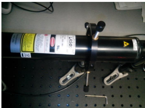
Obr. 1: He-Ne laser Lasos, 5 mW; rovinné zrcátko v držáku Standa
