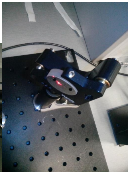
Obr. 1: He-Ne laser Lasos, 5 mW; rovinné zrcátko v držáku Standa
