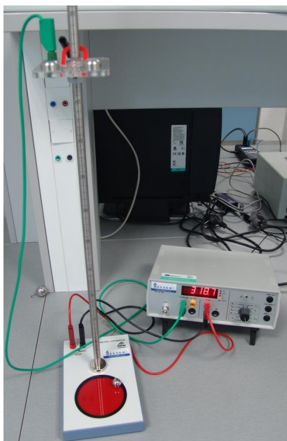
Obrázek 1: Sestava na měření volného pádu a schéma jejího zapojení
