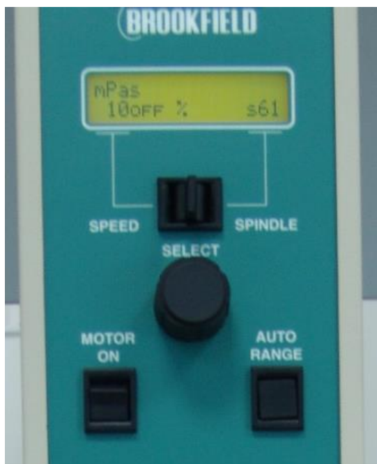
Obrázek 3: Detail přední desky rotačního viskozimetru
