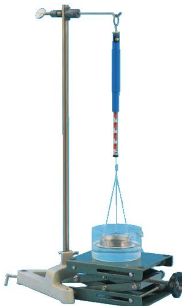
Obrázek 3: Ilustrační obrázek sestavy na měření povrchové napětí kapalin
