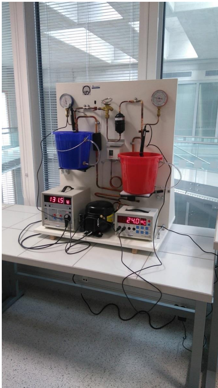
Obr. 2 Zapojené tepelné čerpadlo 389 521
