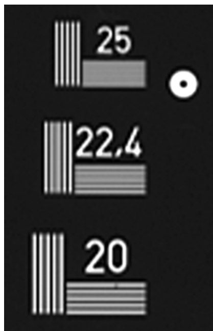
Detail skenu testu při 50 dpm(1270 dpi) - čitelnost dosahuje hodnoty pouhých cca. 20 čar.
