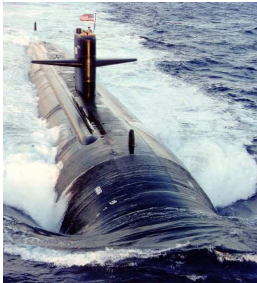
Proudění na čele ponorky je laminární, za čelem se změní na turbulentní.
