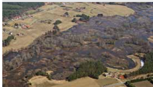
Obr. 4. Jarní rozliv (duben 2006) v úseku přírodě blízké nivy Lužnice u obce Halámky jižně od Suchdola nad Lužnicí. Celkový objem rozlivu byl kvantifikován na 5 mil. m³. Mozaikovitý charakter vegetace podporuje retardaci postupu vody.
