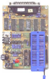
Programátor P-89C5XP je plně totožný s programátorem P-89C5X a navíc místo precizní patice s nulovou silou, kterou ocení ti, kdo programátor budou častěji používat. Programování je jak 5-ti voltové verzi tak také ve 12-ti voltové. Napájecí zdroj a propojovací kabel není součástí programátorů.
